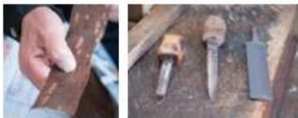
この一枚の中でも、節や穴の開いた部分は使えない。まっすぐの部分のみをなめしてつくった削め具を通して削る。全てが手作業だ。「自分は、釘を使ったらおしまいだと思っています」。穴をあける作業はとても力があるので、釘を使う職人もいるそうだが、横溝さんは昔ながらの山桜の皮にこだわっている。もちろん錆びてしまう釘よりも、断然長持ちする。
